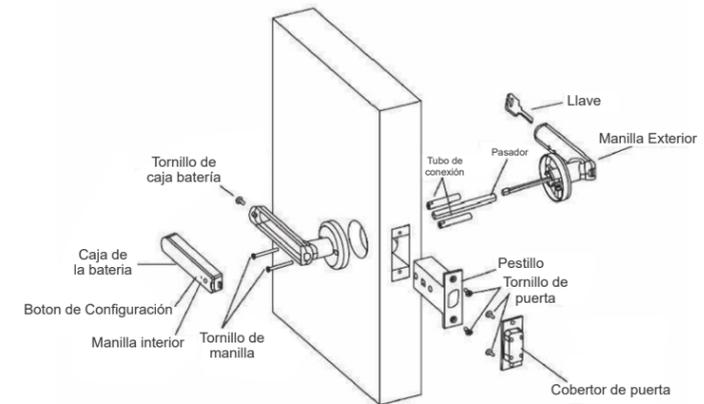
Diagrama de instalación de cerradura de puerta
