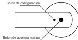
1. Configuración normalmente abierta: presione el botón normalmente abierto durante 1 segundo en la manija rara y la cerradura de la puerta emitirá un sonido de "goteo" para abrir el modo normalmente abierto;
