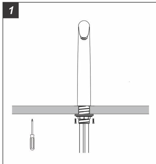
Coloque el grifo en el fregadero correctamente y apriete los dos tornillos de la tuerca hasta que el grifo esté firmemente conectado al fregadero.
