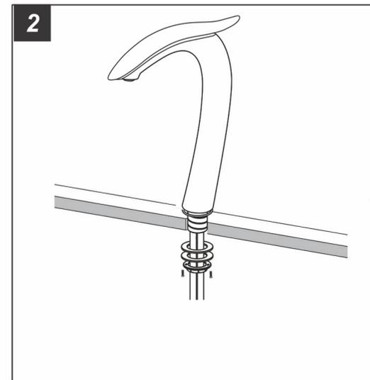
Asegúrese de que el O-Ring esté colocado en la parte inferior de la base. Instale el grifo a través del orificio del fregadero. Desde la parte inferior del fregadero, coloque las juntas y la tuerca de montaje.
