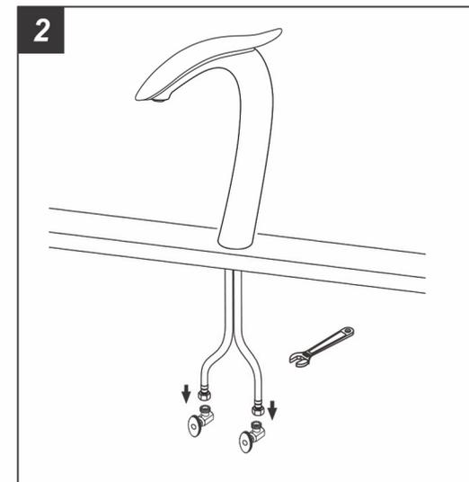
Conecte la manguera flexible de agua fría y caliente a las llaves de arresto.
