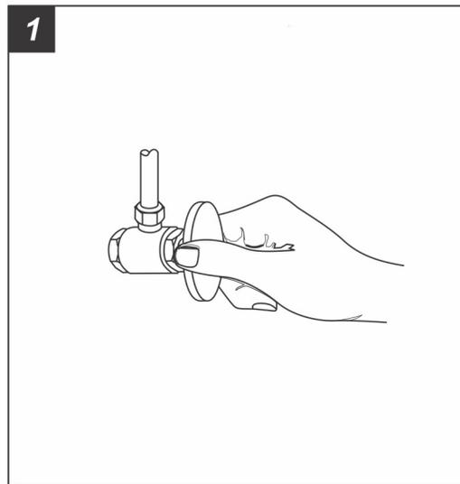
Limpie toda la suciedad de las salidas de las válvulas. Cerrar el suministro de agua. Este generalmente se encuentra cerca del medidor de agua. Si está reemplazando un grifo existente, retire el grifo y limpie bien la superficie del fregadero.
