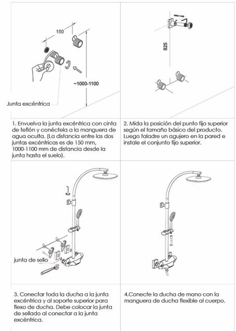
1. Envuelva la junta excéntrica con cinta de Sellón y conéctela a la manguera de agua oculta. (La distancia entre las dos juntas excéntricas es de 150 mm, 1000-1100 mm de distancia desde la junta hasta el suelo).
